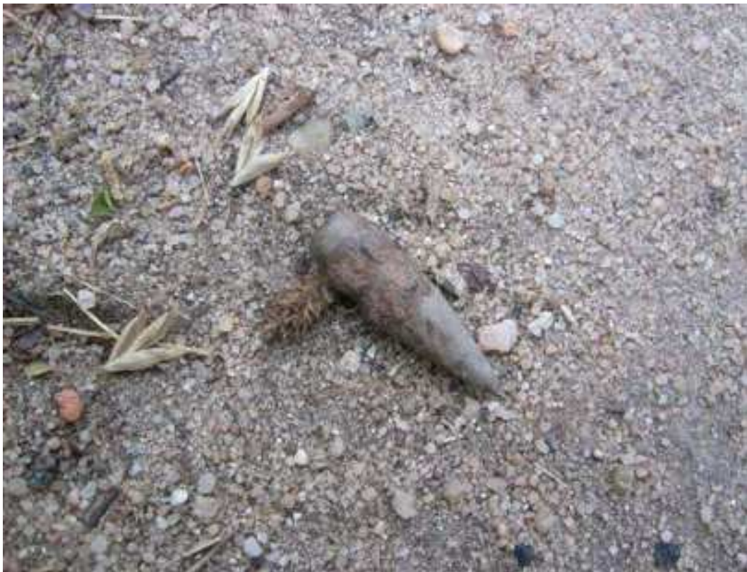
Projektil Kaliber 5,56 x 45 mm. Munition dieses Kalibers wird verschossen aus dem Gewehr M16 und dem leichten Maschinengewehr M249 Squad Automatic Weapon (SAW).
