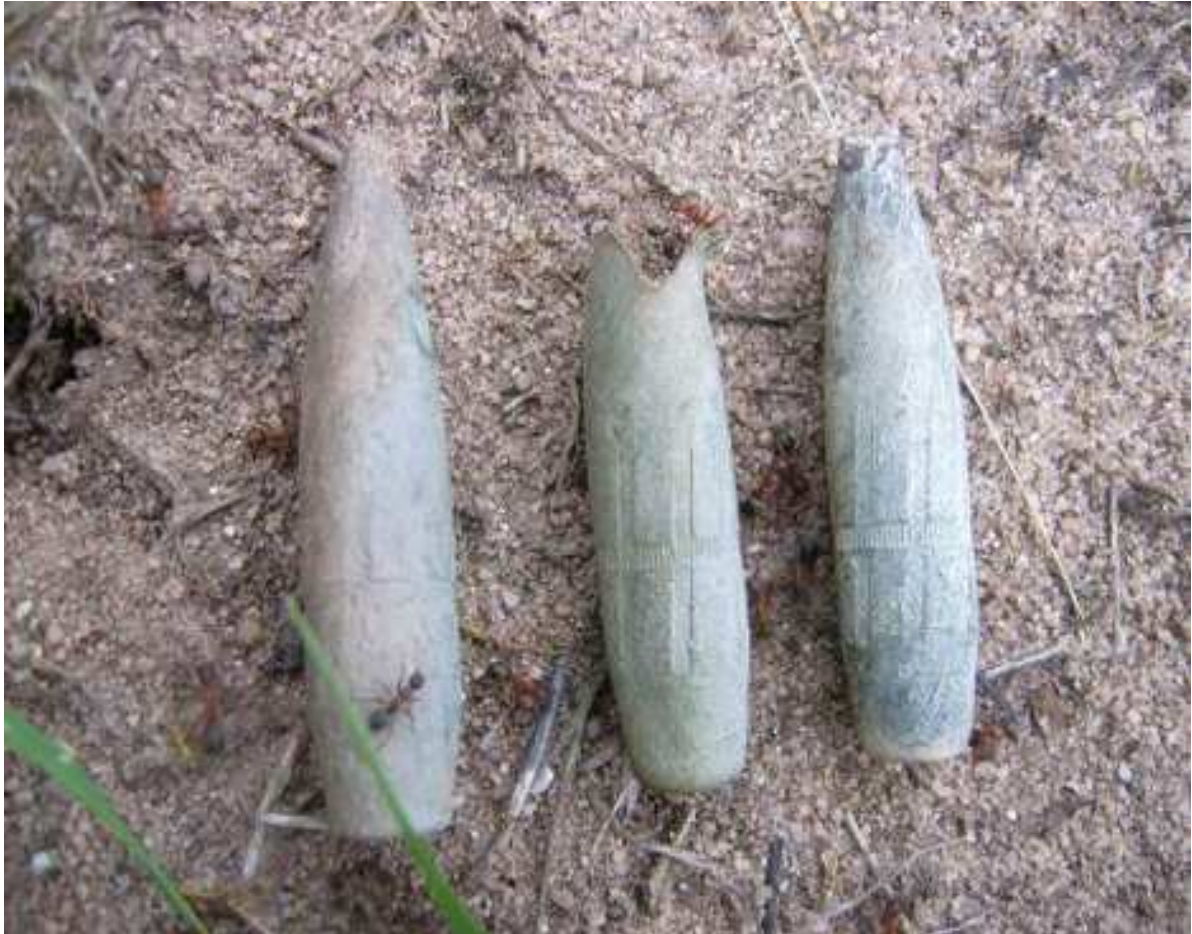
Kaliber . 50 Projektile. Diese aufgefundenen Geschosse weisen zum Teil Deformierungen auf, die beim Einschlag entstanden sind. Auch gut zu sehen die Züge und Felder des Laufs, die sich beim Abschuss in die Oberfläche der Projektile eingekerbt haben.
