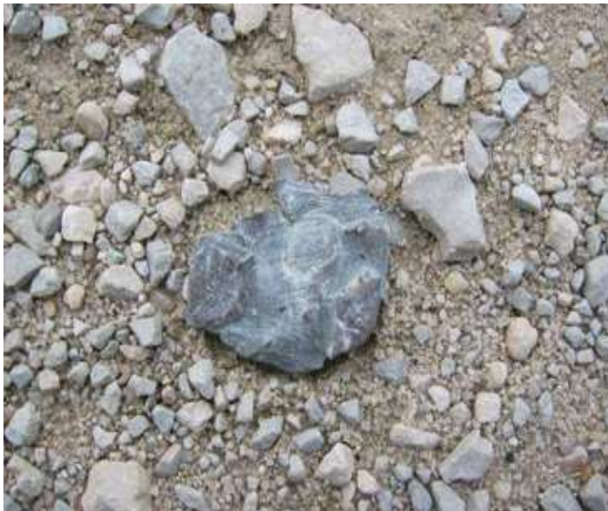
Geschossfragment eines .Kaliber 50 Geschosses, das sich beim Aufschlag zerlegt hat.
